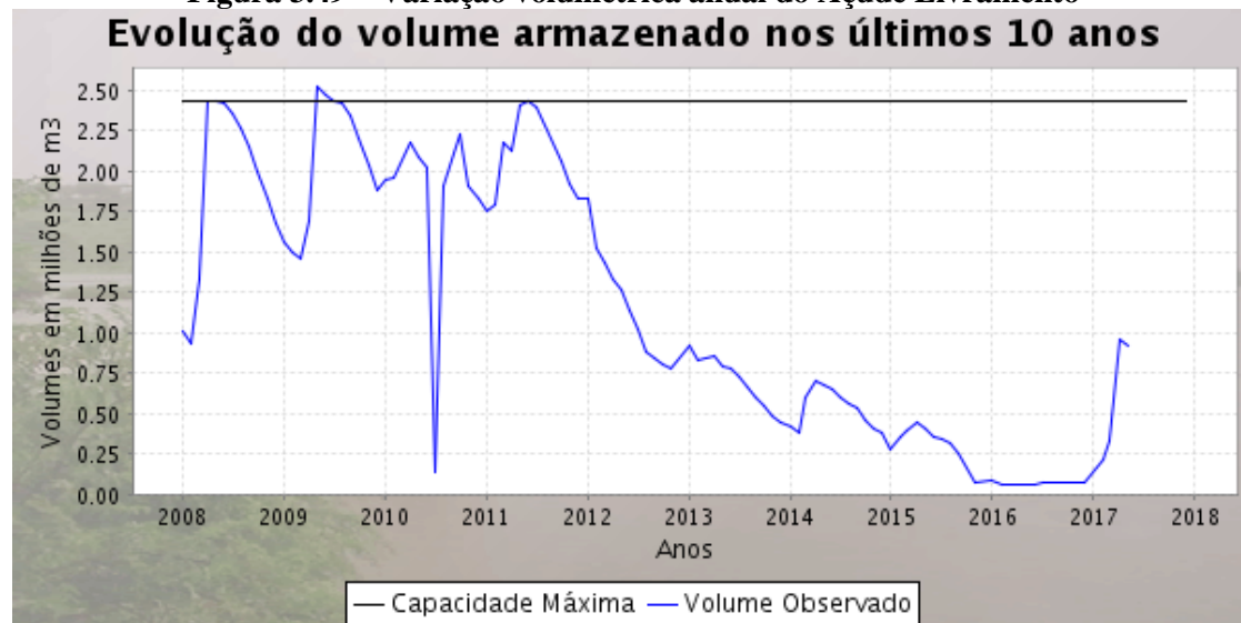
Figura 3.49 – Variação volumétrica anual do Açude Livramento
