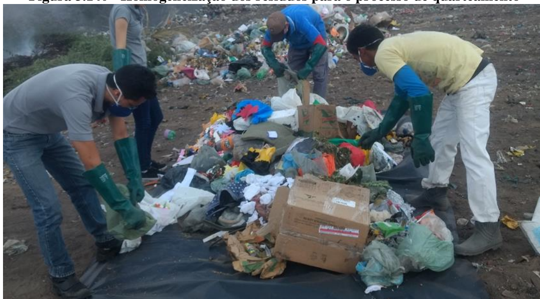
Figura 3.140 - Homogeneização dos resíduos para o processo de quarteamo
