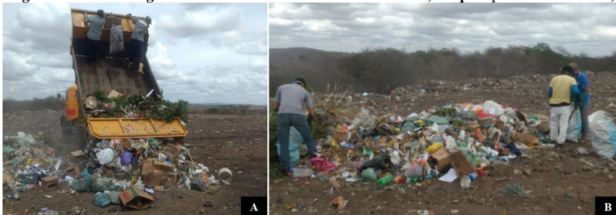
Figura 3.139 - Descarga dos resíduos no vazadouro a céu aberto a) e separação das amostras b)
